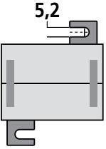
Fissaggio a vite Screw type mounting
