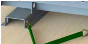
Abbildung 3 – Korrektes Verankern für den Transport
