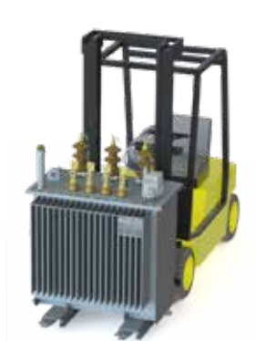
Abbildung 5 - Anheben mit dem Gabelstapler
