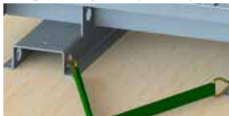
Figura 3 – Anclaje correcto para el transporte
