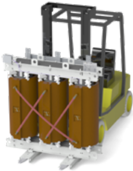
Figure 4 - Levage par chariot élévateur à fourche
